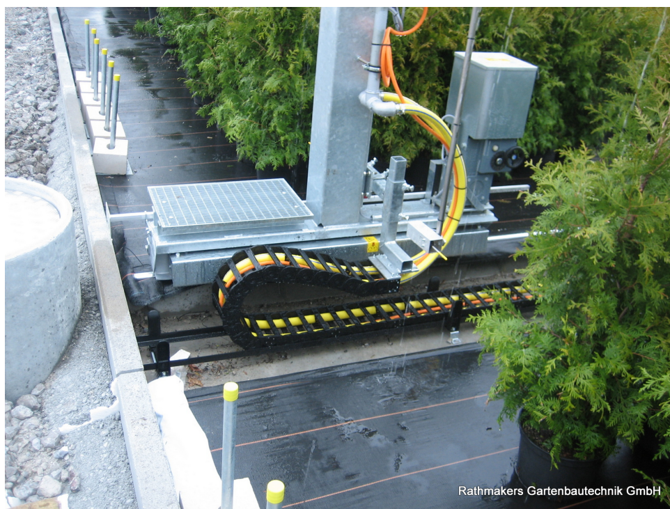
Rys. Nr 8 Polowe ramię zraszające z systemem prowadzenia przewodów w łańcuchu energetycznym
